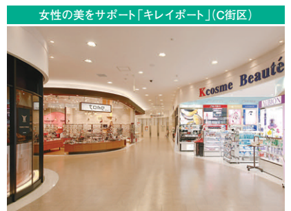
女性の美をサポート「キレイポート」(C街区) 共用回遊通路のベース照明に42Wコンパクト形蛍光灯ダウンライトを採用し、天井壁面側には65Wハロゲンランプダウンライトを配置
